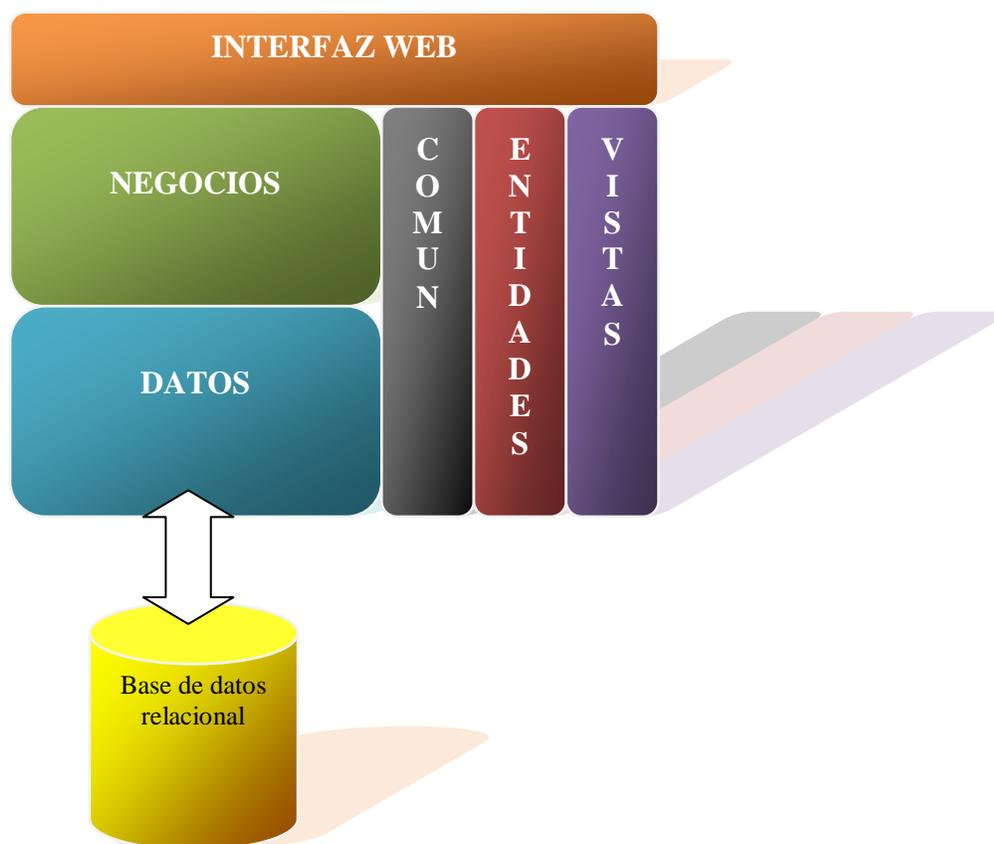
**Figura 8.** Diagrama de arquitectura del sistema
